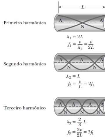
Figura 2: Harmônicos de oscilação de ondas sonoras em tubo aberto.
